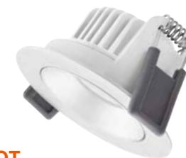
Faretto orientabile e dimmerabile con Power Select per incasso a soffitto. 4 W, 6 W, 8 W tramite dip switch sul driver, design Scale, alloggiamento in alluminio pressofuso, installazione senza attrezzi, in bianco, nero e argento.
