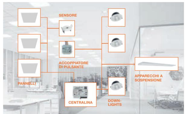
Il sistema VIVARES DALI in un nuovo edificio per uffici: pannelli e downlight sono integrati nei controsoffitti e, utilizzando cavi, sono collegati ai componenti LMS come i sensori. Inoltre, nella sala conferenze sono stati installati apparecchi a sospensione.
