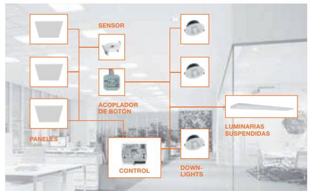
**VIVARES DALI en un nuevo edificio de oficinas:** los paneles y los downlights se integran en los techos suspendidos y, mediante cables, se conectan a los componentes del SGI, como los sensores. Además, se instalaron luminarias suspendidas en la sala de conferencias.
