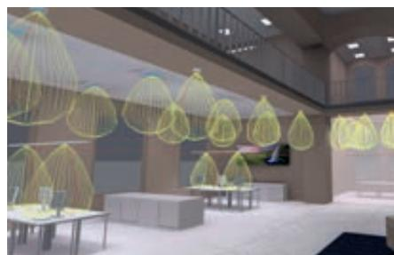
Vista en 3D del posicionamiento equilibrado de los sensores y las fuentes de luz para lograr la distribución lumínica deseada.
